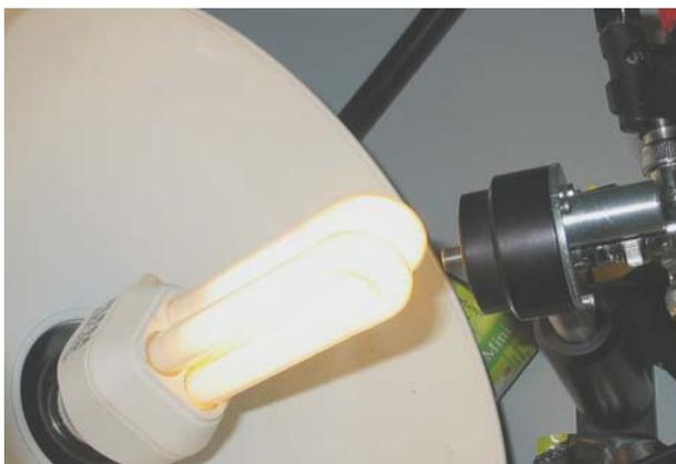
Schnelle Fotodiode misst das Licht einer Energiesparlampe. Ergebnis: es ist getacktet mit 32, 65, 125 und 200 kHz, siehe nebenstehende Frequenzanalyse
