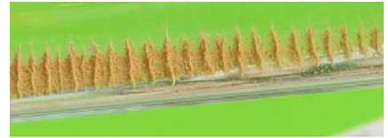
Korkmehl in einer Glasröhre zeigt akustische Schwingungen, die durch einen Lautsprecher am Rohrende angeregt werden.
