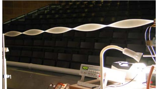
Auf einem Gummiseil bilden sich stehende Wellen aus, wenn man sie mit der passenden Frequenz anregt. Dies
