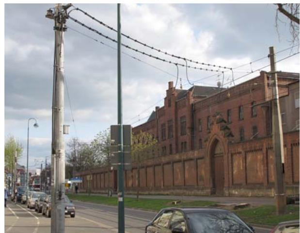
Beim Betrieb von Straßenbahnen benötigt man ein eigenes Stromnetz. In Braunschweig ist es Gleichspannung bei 500 Volt (l.u.). Die Einspeisung erfolgt über Erdkabel bis zur Oberleitung. (o.: Erfurt).
