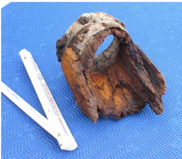
Holzrohr mit Einschlagring aus Eisen zum Verbinden der Rohre untereinander
