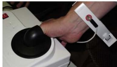
Kompaktgerät mit Hochspannung und elektronischer Kamera. Der Gummideckel schützt gegen Fremdlicht bei der Messung.
