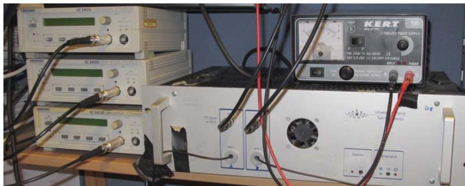
Verstärker für die beiden Photodioden (rechts unten). Links daneben Zähler und zwar jeweils einen Zähler für die
