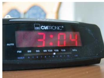
Radiowecker. Der Strom für die roten Leuchtdioden ist nicht konstant, sondern wird permanent geschaltet (Multiplex)
