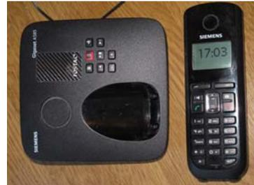
DECT-Telefon und Basisstation, mit ECO-Modus, ältere Versionen senden 24 Stunden am Tag
