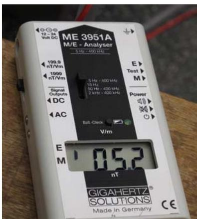
In größerer Stückzahl von einer anderen Firma gefertigtes Meßgerät zu Anzeige von elektrischen und magnetischen Wechselfeldern.
