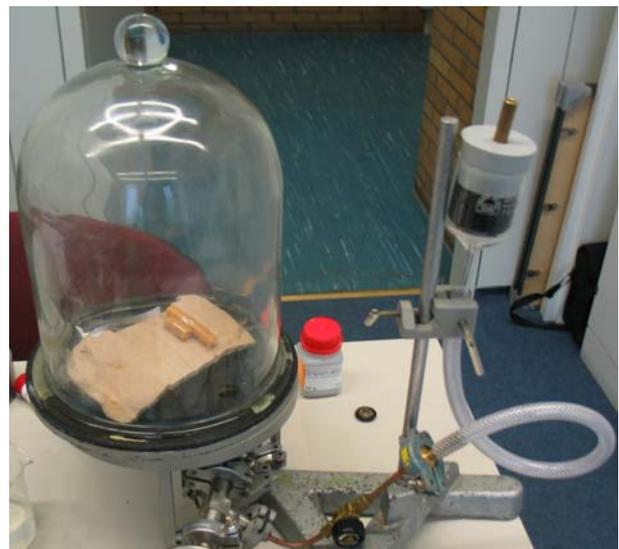
Vakuumglocke mit Aktivkohle im Lufteinlass (Ozon-Filter) Die Probe (Wachskerze) liegt nicht auf der Grundplatte, sondern auf Pappe, damit sie „unsichtbar“ wird.
