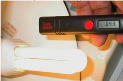
Energiesparlampe enthält ein Schaltnetzteil, das den Strom taktet und Magnetfelder erzeugt.
