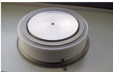
Für die Umrichtung von Gleich- auf Wechselstrom und umgekehrt (Hochspannung Gleichstrom Übertragung, Baltic-Cable, l.u.) beziehungsweise von Normalnetz auf Bahnstrom (Umrichter Karlsfeld) (u.) verwendet man Thyristoren (l) mit Ansteuerung über optische Fasern. Diese Schaltelemente sind wassergekühlt über Kunststoffschläuche mit entionisiertem Wasser.
