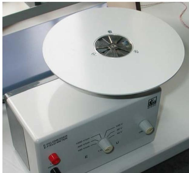
Feldmühle, rotierender Plattenkondensator in Form von Windmühlenflügeln.
