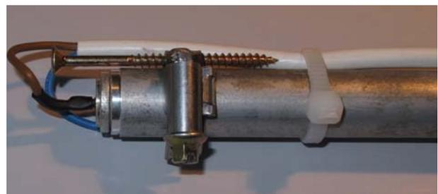
Diode und Aluminiumrohr als Kollimator und Kühlkörper
