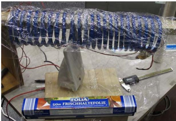
Wasserspule abgeschirmt durch Haushaltsfolie
