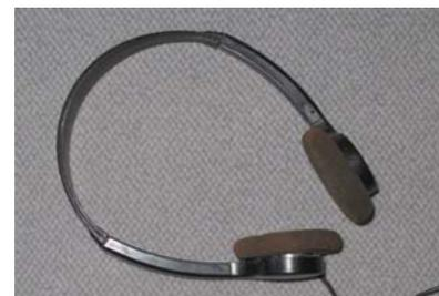
Kopfhörer, für die Bewegung der Membran verwendet man wechselnde Magnetfelder.
