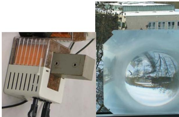
Versuchsaufbau nachgestellt: Spule, Eisenkern und Fresnellinse
