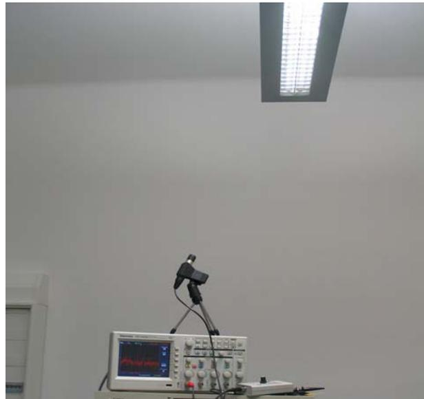
Leuchtstofflampe mit Schaltnetzteil 75 kHz. Die Auswirkungen, Ultraschall und magnetische Wechselfelder, lassen sich noch gut in einem Meter Entfernung messen. Der Aluminiumreflektor über der Röhre wirkt dabei wie ein Hohlspiegel, der die Schallintensität an einigen Stellen darunter deutlich erhöht. Als Beleuchtung für einen Arbeitsplatz direkt unter der Lampe ist diess Gerät sehr schlecht geeignet, da nicht streßfrei.
