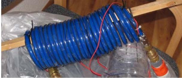
Wasserspule mit Kupferdraht
