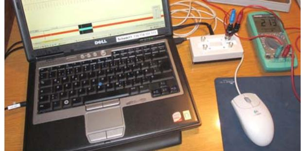
Die Modulation der Wasserspule erfolgt über einen Wechselstrom (hier Anzeige 213 mikroAmpere).
